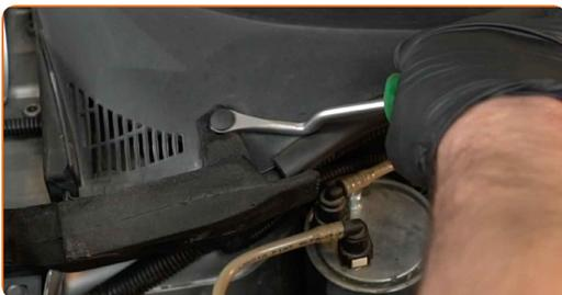
**4** Schrauben Sie die Befestigung der Windlaufabdeckung auf. Verwenden Sie einen Kreuzschlitzschraubendreher.
