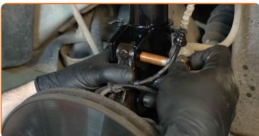
**47** Schrauben Sie das Befestigungselement ein, das das Federbein mit dem Achsschenkel verbindet. Verwenden Sie Ring-Gabelschlüssel Nr. 18. Verwenden Sie Stecknuss Nr. 18. Verwenden Sie einen Ratschenschlüssel.
