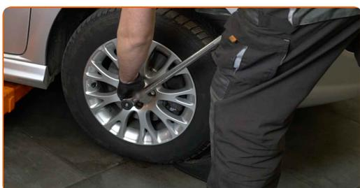
**59** Entfernen Sie den Wagenheber sowie die Unterlegkeile.
