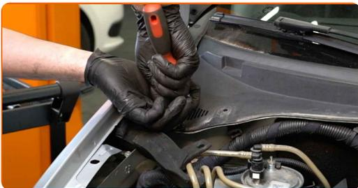
**64** Bringen Sie die Befestigungselemente der Windlaufabdeckung an.
