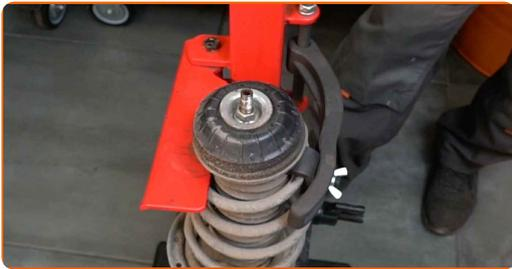
**26** Behandeln Sie die Federbeinstange. Benutzen Sie eine Drahtbürste. Benutzen Sie WD-40-Spray.
