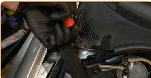
**5** Entfernen Sie die Dichtung der Windabweiserabdeckung.
