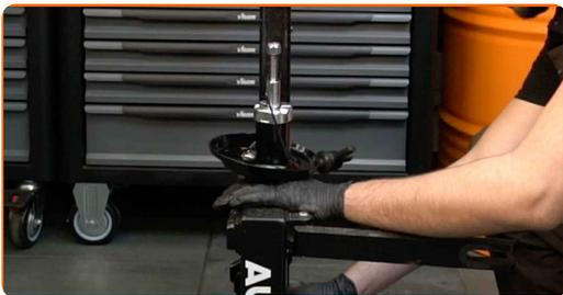
**34** Installieren Sie die Feder am Stoßdämpfer.
