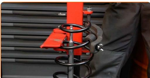
**36** Installieren Sie die Staubschutzmanschette und den Anschlagpuffer auf dem neuen Stoßdämpfer.
