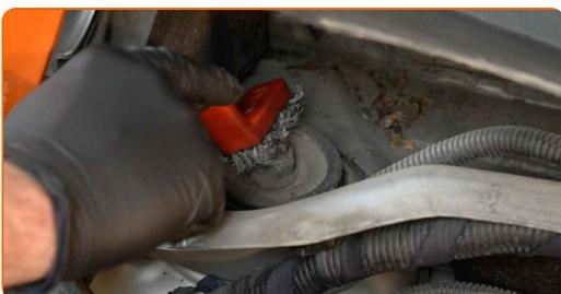
**8** Lösen Sie die obere Befestigung des Domlagers. Verwenden Sie Ring-Gabelschlüssel Nr. 18. Verwenden Sie Inbusschlüssel Nr. H6. Verwenden Sie einen Ratschenschlüssel.
