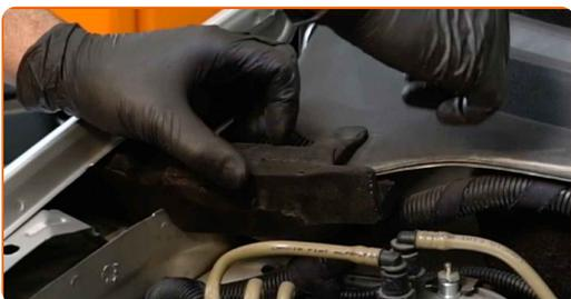
**65** Bauen Sie die Dichtung der Windabweiserabdeckung ein.
