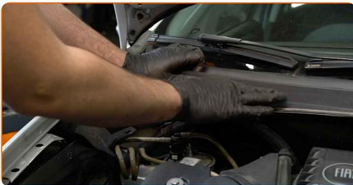
**63** Ziehen Sie die Befestigungen der Windlaufabdeckung fest. Verwenden Sie einen Kreuzschlitzschraubendreher.
