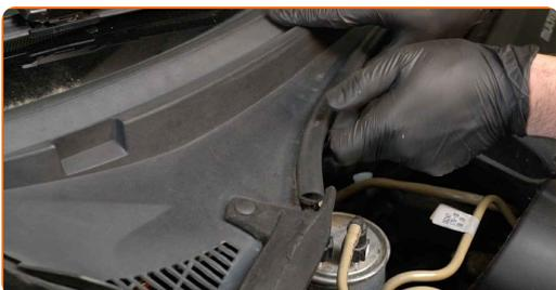
**66** Entfernen Sie die Kotflügel-Abdeckung.
