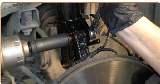
**48** Entfernen Sie den Träger unter dem Achsschenkel.
