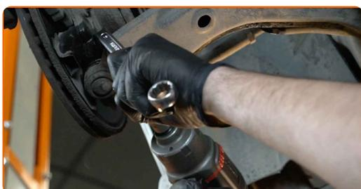
**8** Entfernen Sie die Befestigungsschraube.
