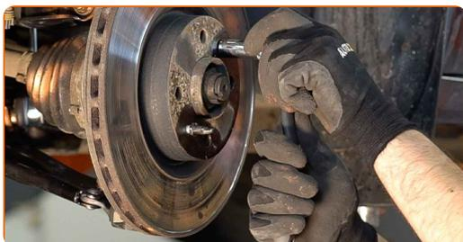
**18** Entfernen Sie die Bremsscheibe.
