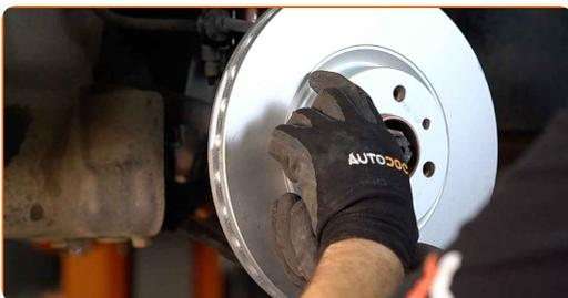
**21** Ziehen Sie die Befestigung der Bremsscheibe fest. Verwenden Sie Stecknuss Nr. 12. Verwenden Sie einen Drehmomentschlüssel. Ziehen Sie ihn mit 10 Nm Drehmoment fest.
