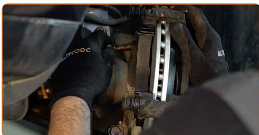
**24** Befestigen Sie die Bremssattelhalterung. Verwenden Sie Stecknuss Nr. 19. Verwenden Sie einen Drehmomentschlüssel. Ziehen Sie ihn mit 110 Nm Drehmoment fest.
