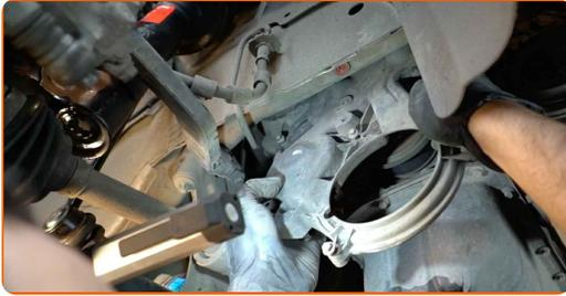
**39** Schrauben Sie die Befestigung des Kurbelwellensensors ab. Verwenden Sie Stecknuss Nr. 8. Verwenden Sie einen Ratschenschlüssel.
