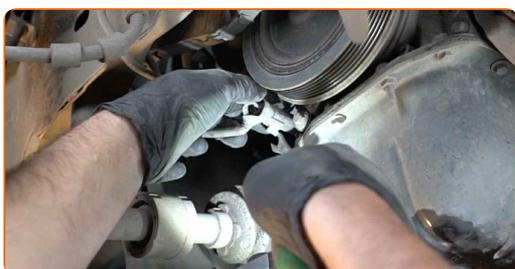
**29** Lösen Sie die Verkabelung des Kurbelwellensensors. Verwenden Sie einen Lösehebel, um die Clips zu entfernen.
