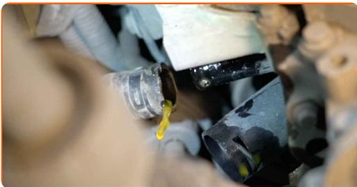
**51** Schrauben Sie die Befestigungen der Halterung der Klimaanlageleitungen ab. Verwenden Sie Stecknuss Nr. 10. Verwenden Sie einen Ratschenschlüssel.
