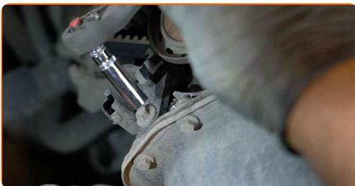
**40** Entfernen Sie den Kurbelwellensensor.
