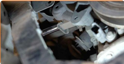
**32** Entfernen Sie den Deckel der Kurbelwellenriemenscheibe. Verwenden Sie einen flachen Schraubendreher.
