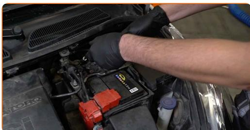
**4** Entfernen Sie die Batterieklemmen.
