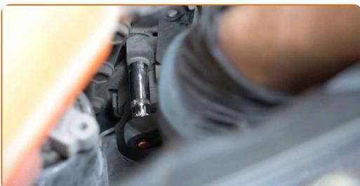
**25** Entfernen Sie die Halterung des Lichtmaschinenkabelbaums.
