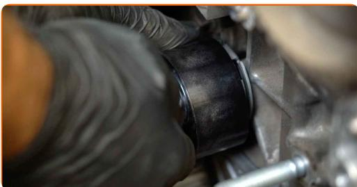
**79** Schraube die Befestigung der Spannrolle des Zahnriemens ein. Verwenden Sie Ring-Gabelschlüssel Nr. 13.
