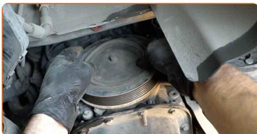
**124** Schraube die Befestigungen der Halterung des Motorkabelbaums ein. Verwenden Sie Stecknuss Nr. 8. Verwenden Sie einen Ratschenschlüssel.
