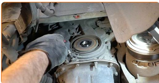
**38** Entfernen Sie die untere Zahnriemenabdeckung.
