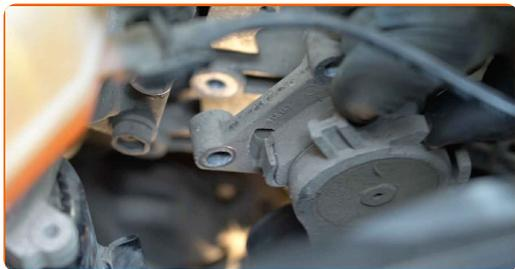
**26** Schrauben Sie die Befestigung der Spannrolle des Keilrippenriemens ab. Verwenden Sie Stecknuss Nr. 10. Verwenden Sie einen Ratschenschlüssel.
