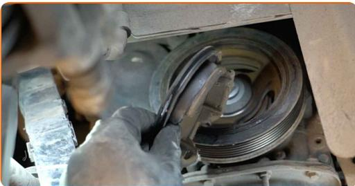
**33** Drehen Sie die Kurbelwellenriemenscheibe. Verwenden Sie Stecknuss Nr. 18. Verwenden Sie einen Ratschenschlüssel.
