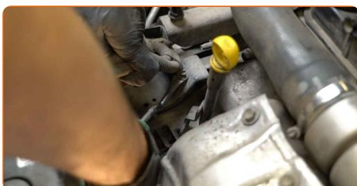
**20** Trennen Sie den Steckverbinder des Motorkabelbaums.
