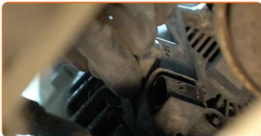
**17** Schrauben Sie die Befestigung des Lichtmaschinenkabelbaums ab. Verwenden Sie Stecknuss Nr. 13. Verwenden Sie einen Ratschenschlüssel.
