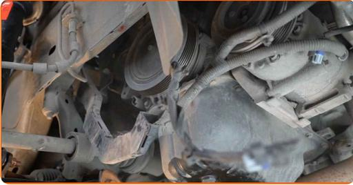
**31** Schrauben Sie die Befestigungen der Halterung des Motorkabelbaums ab. Verwenden Sie Stecknuss Nr. 8. Verwenden Sie einen Ratschenschlüssel.
