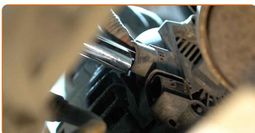
**18** Lösen Sie den Lichtmaschinenkabelbaum.
