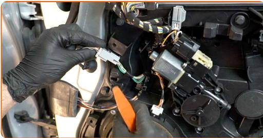
**14** Entfernen Sie den Steckverbinder des Spiegelverstellungsschalters von der Tür. Verwenden Sie einen Zierleistenkeil.
