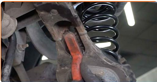
**27** Montieren Sie den Querlenker.
