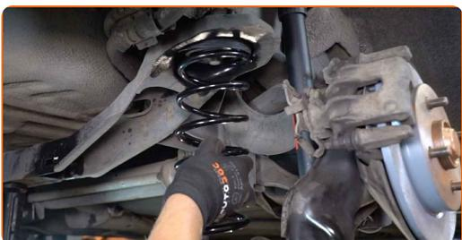
**18** Stützen Sie den Arm. Benutzen Sie einen hydraulischen Getriebeheber. Benutzen Sie ein Brecheisen.
