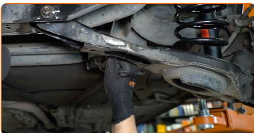
**28** Ziehen Sie das Befestigungselement an, das die Druckstange mit dem Stabilisator verbindet. Verwenden Sie Ring-Gabelschlüssel Nr. 13. Verwenden Sie Stecknuss Nr. 13. Verwenden Sie einen Drehmomentschlüssel. Ziehen Sie ihn mit 15 Nm Drehmoment fest.
