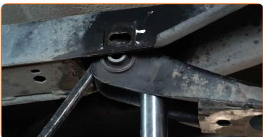
**19** Bringen Sie die Befestigungsschraube an. Verwenden Sie Ring-Gabelschlüssel Nr. 19.
