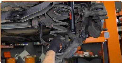
**16** Reinigen Sie die Aufnahmen der Spiralfedern. Benutzen Sie eine Drahtbürste. Benutzen Sie WD-40-Spray.
