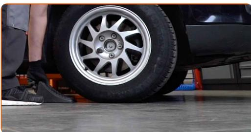
**13** Lösen Sie die Radhalterungsschrauben. Verwenden Sie eine Schlagnuss für Felgen # 19.
