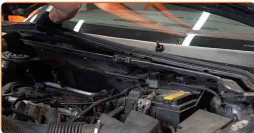
**11** Lösen Sie die oberen Befestigungselemente des Federbeinstützlagers. Verwenden Sie Stecknuss Nr. 13. Verwenden Sie einen Ratschenschlüssel.
