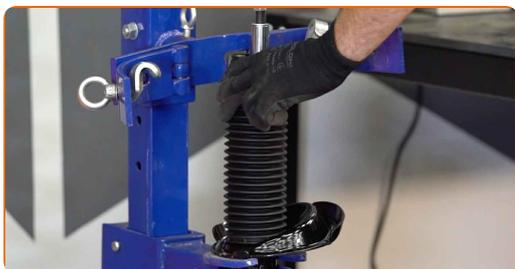
**36** Installieren Sie die Feder am Stoßdämpfer.
