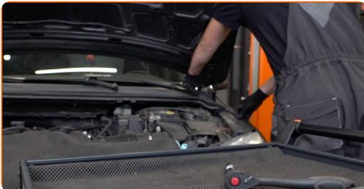
**4** Lösen Sie die Befestigungen der Frontscheibenwischerarme. Verwenden Sie Stecknuss Nr. 15. Verwenden Sie einen Ratschenschlüssel.
