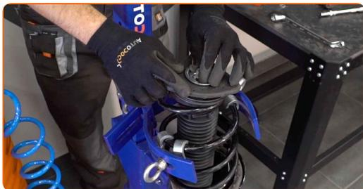
**39** Ziehen Sie die Federbeinkolbenstangenmutter an. Verwenden Sie Inbusschlüssel Nr. H6. Verwenden Sie Ring-Gabelschlüssel Nr. 19. Verwenden Sie einen Drehmomentschlüssel. Ziehen Sie ihn mit 50 Nm Drehmoment fest.
