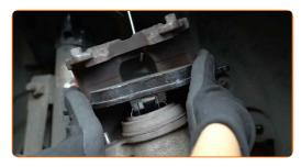
23 Installieren Sie den Bremssattel und fixieren Sie diesen.
