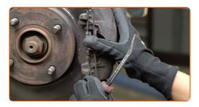
Entfernen Sie den Bremssattel.
