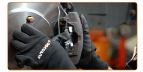
Ziehen Sie die Bremssattelbefestigungen fest. Verwenden Sie Inbusschlüssel Nr. H7. Verwenden Sie einen Drehmomentschlüssel. Ziehen Sie ihn mit 28 Nm Drehmoment fest.
