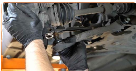
**14** Entfernen Sie die vordere Befestigung des Querlenkers.
