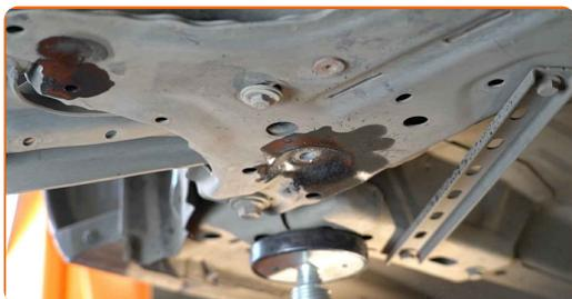
**12** Setzen Sie das Verbindungselement, welches das Kugelegelenk mit dem Achsschenkel verbindet, frei. Verwenden Sie einen flachen Metallmeißel. Benutzen Sie einen Hammer.
