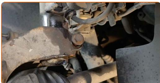
**46** Schrauben Sie das Befestigungselement ein, das das Federbein mit dem Achsschenkel verbindet. Verwenden Sie Stecknuss Nr. 15. Verwenden Sie einen Ratschenschlüssel.
