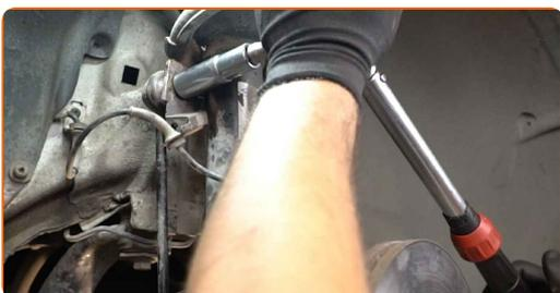
**65** Behandeln Sie die Federbein-Befestigungen. Behandeln Sie das Befestigungselement, das den Spurstangenkopf mit dem Achsschenkel verbindet. Behandeln Sie die Befestigungen des Kugelgelenks. Benutzen Sie ein Kupferschmiermittel.
