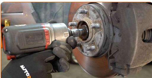
**13** Entfernen Sie die Befestigungsschraube.
