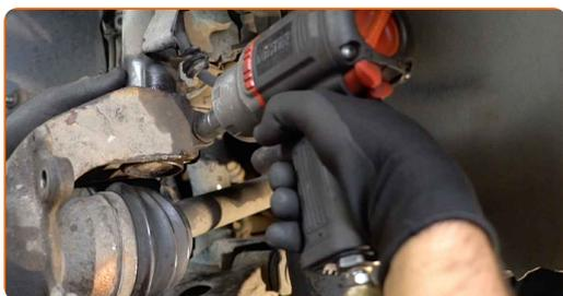
**47** Schrauben Sie das Befestigungselement ein, das das Kugelgelenk mit dem Achsschenkel verbindet. Verwenden Sie Ring-Gabelschlüssel Nr. 21.
