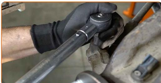
**52** Ziehen Sie das Kugelgelenk an. Verwenden Sie Ring-Gabelschlüssel Nr. 21. Verwenden Sie einen Drehmomentschlüssel. Ziehen Sie ihn mit 70 Nm Drehmoment fest.
