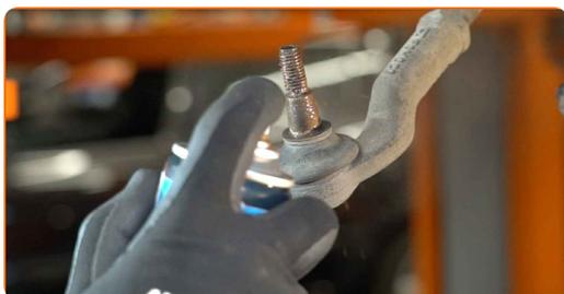
**49** Bauen Sie den Spurstangenkopf an dem Achsschenkel an.
