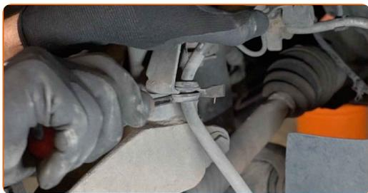
**17** Die Befestigungselemente der Bremssattelhalterung reinigen. Benutzen Sie eine Drahtbürste. Benutzen Sie WD-40-Spray.
