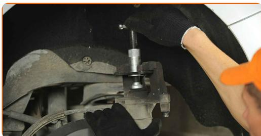
**19** Installieren Sie den Bremssattel und fixieren Sie diesen.
