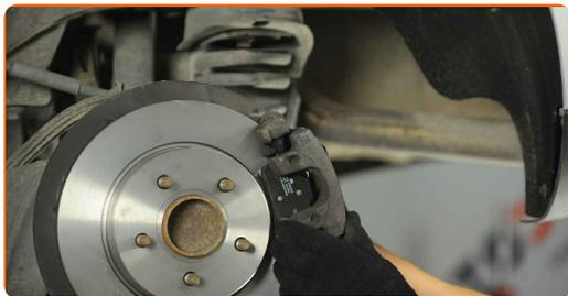
**20** Reinigen Sie die Bremssattel-Führungsstifte.
