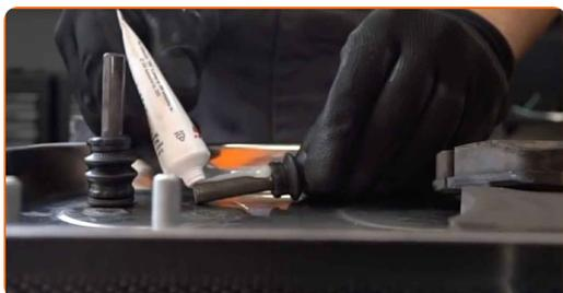
**22** Schrauben Sie die Führungsbolzen hinein.
