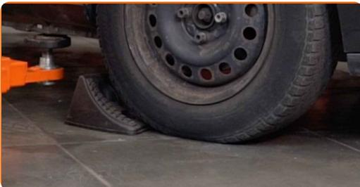
**3** Lösen Sie die Radhalterungsschrauben. Verwenden Sie eine Schlagnuss für Felgen # 19.
