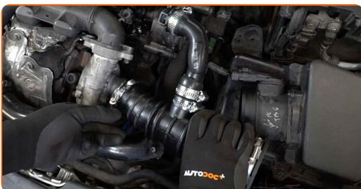
**10** Verbinden Sie auf der rechten Seite den Schlauch des PCV-Ventils mit der Motorabdeckung.
