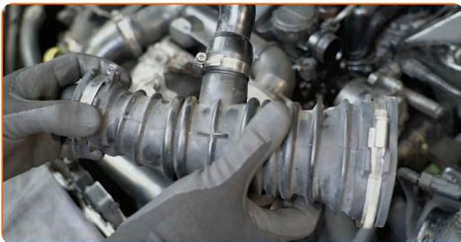
**8** Reinigen Sie den Montagesitz des Lufteinlassschlauchs.
