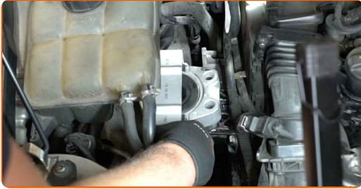
**14** Ziehen Sie die Befestigungsschrauben des Motorlagers an. Verwenden Sie Stecknuss Nr. E11. Verwenden Sie einen Drehmomentschlüssel. Ziehen Sie ihn mit 32 Nm Drehmoment fest.
