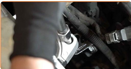
**15** Schrauben Sie die Befestigungen, die das Motorlager mit der Karosserie verbinden, fest. Verwenden Sie Stecknuss Nr. 18. Verwenden Sie einen Drehmomentschlüssel. Ziehen Sie ihn mit 65 Nm Drehmoment fest.
