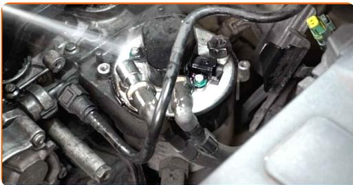
**9** Trennen Sie die Kraftstoffversorgungsleitungen vom Kraftstofffilter. Verwenden Sie einen flachen Schraubendreher.
