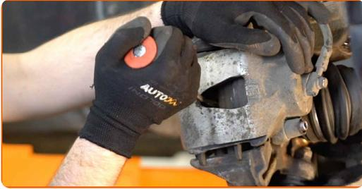
**16** Entfernen Sie den Bremssattel.
