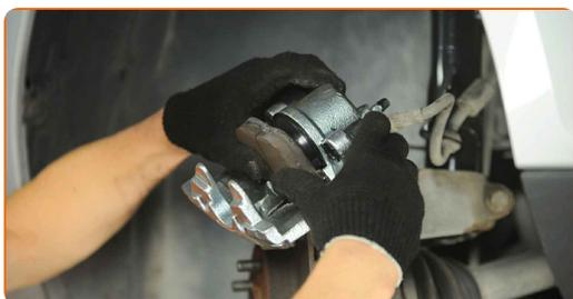
Austausch: Bremssattel – FORD FOCUS III Kasten/Schrägheck. AUTODOC-Experten empfehlen:
