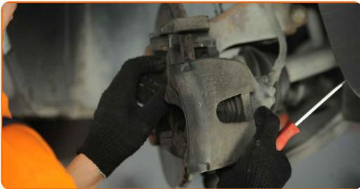
**Austausch: Bremssattel – FORD FOCUS III Kasten/Schrägheck. Tipp von AUTODOC-Experten:**
