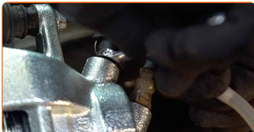
**35** Entlüften Sie das Bremssattelsystem. Ohne das Starten des Motors drücken Sie das Bremspedal mehrmals, bis Sie signifikanten Widerstand spüren.
