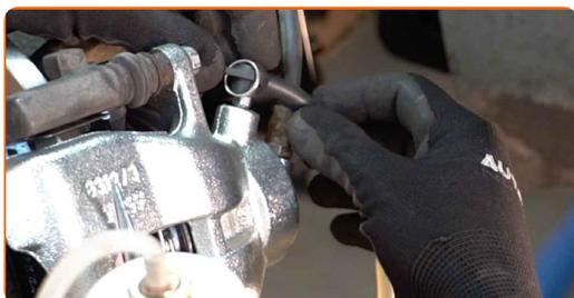
**34** Lösen Sie die Bremsentlüftungsschraube. Verwenden Sie Ring-Gabelschlüssel Nr. 9.
