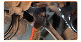
Schrauben Sie die Armbefestigung vom Balken ab. Verwenden Sie Stecknuss Nr. 15. Verwenden Sie einen Ratschenschlüssel. Verwenden Sie ein Windeisen. Entfernen Sie die Befestigungsschraube.
