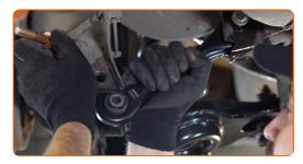
Bringen Sie die Befestigungen des Querlenkers an. Benutzen Sie ein Brecheisen.
