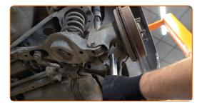
Reinigen Sie die Befestigungen des Querlenkers. Benutzen Sie eine Drahtbürste. Benutzen Sie WD-40-Spray.
