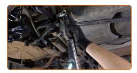
Ziehen Sie die Befestigungen an, die den Querlenker mit dem Hinterachsgelenk verbinden. Verwenden Sie Stecknuss Nr. 15. Verwenden Sie einen Drehmomentschlüssel. Ziehen Sie ihn mit 115 Nm Drehmoment fest.
