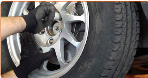
23 Senken Sie das Auto und ziehen Sie die Radschrauben über Kreuz an. Verwenden Sie einen Drehmomentschlüssel. Ziehen Sie ihn mit 110 Nm Drehmoment fest.
