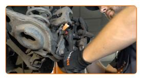
Entfernen Sie die Sattelhalterung.
