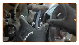
Installieren Sie den Bremssattel und fixieren Sie diesen. Verwenden Sie Ring-Gabelschlüssel Nr. 15. Verwenden Sie Stecknuss Nr. 13. Verwenden Sie einen Drehmomentschlüssel. Ziehen Sie ihn mit 35 Nm Drehmoment fest.
