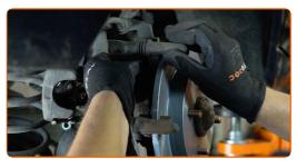
Befestigen Sie die Bremssattelhalterung. Verwenden Sie Stecknuss Nr. 13. Verwenden Sie einen Drehmomentschlüssel. Ziehen Sie ihn mit 55 Nm Drehmoment fest.
