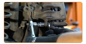
Das Kabel der Feststellbremse in die Bremssattelhalterung einbauen. Verwenden Sie eine Wasserpumpenzange.
