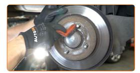
Lösen Sie die Befestigung der Bremsscheibe. Benutzen Sie ein Brecheisen.
