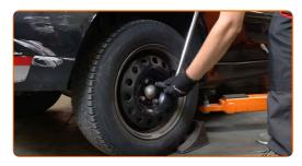
Entfernen Sie den Wagenheber sowie die Unterlegkeile.
