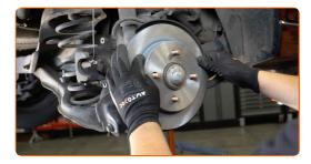
Schrauben Sie die Bremsscheibenbefestigung ein. Benutzen Sie ein Brecheisen.
