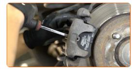
Entfernen Sie den Bremssattel.
