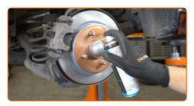
Die Bremsscheibenoberfläche reinigen. Benutzen Sie einen Bremsenreiniger.
