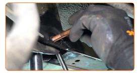
20 Entfernen Sie den Träger unter dem Arm.
