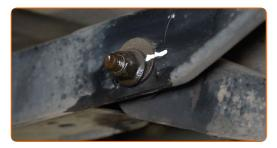
Schrauben Sie die Armbefestigung vom Balken ab. Verwenden Sie Ring-Gabelschlüssel Nr. 19. Verwenden Sie Stecknuss Nr. 18. Verwenden Sie ein Windeisen.
