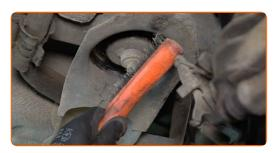
Bauen Sie die Spiralfeder zusammen mit den Gummilager in deren Aufnahmen ein.
