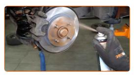
Die Bremsscheibenoberfläche reinigen. Benutzen Sie einen Bremsenreiniger.
