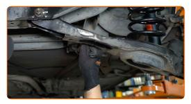
Ziehen Sie das Befestigungselement an, das die Druckstange mit dem Stabilisator verbindet. Verwenden Sie Ring-Gabelschlüssel Nr. 13. Verwenden Sie Stecknuss Nr. 13. Verwenden Sie einen Drehmomentschlüssel. Ziehen Sie ihn mit 15 Nm Drehmoment fest.
