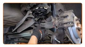
Stützen Sie den Arm. Benutzen Sie einen hydraulischen Getriebeheber. Benutzen Sie ein Brecheisen.
