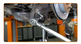
Entfernen Sie den Träger unter dem Arm.
