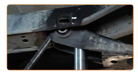
Bringen Sie die Befestigungsschraube an. Verwenden Sie Ring-Gabelschlüssel Nr. 19.
