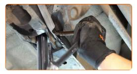
Entfernen Sie den Träger unter dem Arm. Benutzen Sie ein Brecheisen.
