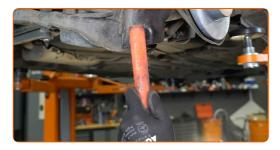
Drehen Sie Befestigungselement auf, das den Querlenker mit dem hinteren Achsschenkel verbindet. Verwenden Sie Stecknuss Nr. 15. Verwenden Sie ein Windeisen.
