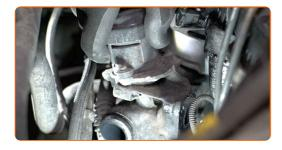
Reinigen Sie den Montagesitz des AGR-Ventils. Verwenden Sie Allzweckreinigungsspray.
