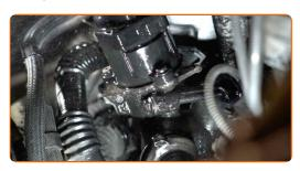
Trennen Sie den Steckverbinder des AGR-Ventils.
