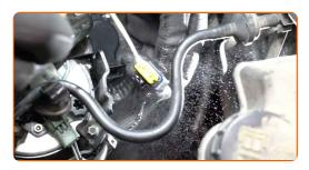
17 Stecken Sie den Steckverbinder des AGR-Ventils ein.
