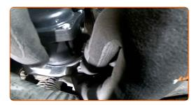
Schrauben Sie die Befestigungen des AGR-Ventils fest. Verwenden Sie Stecknuss Nr. 8. Verwenden Sie einen Drehmomentschlüssel. Ziehen Sie ihn mit 9 Nm Drehmoment fest.
