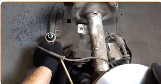
**20** Schrauben Sie das untere Befestigungselement ab, dass das Federbein mit dem Achsschenkel verbindet. Verwenden Sie Stecknuss Nr. 18. Verwenden Sie einen Ratschenschlüssel. Verwenden Sie ein Windeisen.
