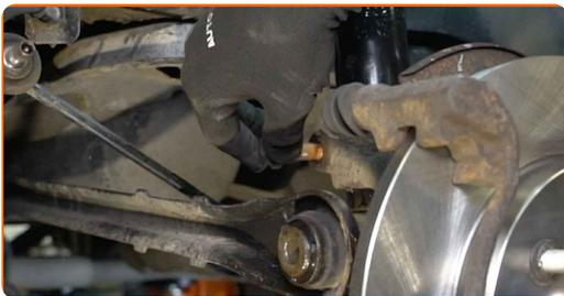
**59** Schrauben Sie die Befestigung an, die den Stoßdämpfer mit dem hinteren Achsschenkel verbindet. Verwenden Sie Stecknuss Nr. 18. Verwenden Sie einen Ratschenschlüssel.
