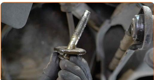
**17** Reinigen Sie alle Verbindungen des Querlenkers. Benutzen Sie eine Drahtbürste. Benutzen Sie WD-40-Spray.
