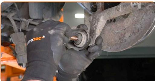
**61** Schrauben Sie die Befestigungen ein, die den Querlenker mit dem Hinterachsgelenk verbinden. Verwenden Sie Stecknuss Nr. 15. Verwenden Sie einen Ratschenschlüssel.
