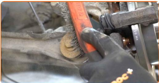
**15** Schrauben Sie die Befestigung heraus, die den Querlenker mit dem Hinterachsgelenk verbindet. Verwenden Sie Stecknuss Nr. 15. Verwenden Sie einen Ratschenschlüssel.
