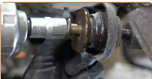
**16** Entfernen Sie die Befestigungsschraube. Lösen Sie den Querlenker.
