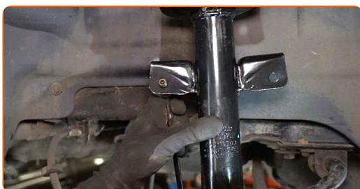
**76** Ziehen Sie die Befestigungselemente des Stabilenkers fest. Verwenden Sie Stecknuss Nr. 17. Verwenden Sie einen Ratschenschlüssel.
