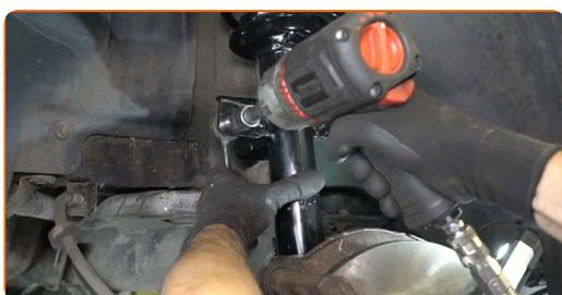
**77** Ziehen Sie das Befestigungselement an, das die Druckstange mit dem Federbein verbindet. Verwenden Sie Stecknuss Nr. 17. Verwenden Sie einen Drehmomentschlüssel. Ziehen Sie ihn mit 48 Nm Drehmoment fest.
