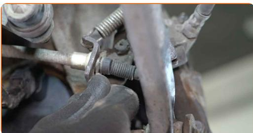
**74** Reinigen Sie die Montagesitze der Koppelstange. Benutzen Sie eine Drahtbürste. Benutzen Sie WD-40-Spray.
