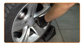
Entfernen Sie den Wagenheber sowie die Unterlegkeile.
