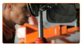
Ziehen Sie das vordere Befestigungselement an, das den Querlenker mit dem Hilfsrahmen verbindet. Verwenden Sie Stecknuss Nr. 15. Verwenden Sie einen Drehmomentschlüssel. Ziehen Sie ihn mit 80 Nm Drehmoment fest.+60°
