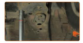
Ziehen Sie das Befestigungselement der Halterung an, die den Querlenker mit der Karosserie verbindet. Verwenden Sie Stecknuss Nr. 21. Verwenden Sie einen Drehmomentschlüssel. Halten Sie das empfohlene Anzugsdrehmoment ein.
