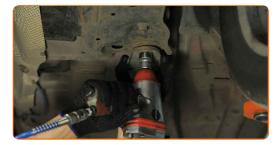
Stützen Sie den Arm. Benutzen Sie einen hydraulischen Getriebeheber.
