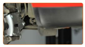
Schrauben Sie die vordere Armbefestigung an. Verwenden Sie Stecknuss Nr. 15. Verwenden Sie einen Ratschenschlüssel.
