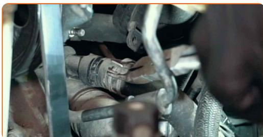
**19** Ziehen Sie die Kühlmittelschläuche vom Thermostatgehäuse ab.
