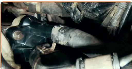
**29** Befestigen Sie die Klemmen der Kühlmittelschläuche. Verwenden Sie eine Clic-R-Kragenzange.
