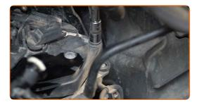
10 Entfernen Sie den Kraftstofffilter.
