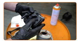
16 Installieren Sie einen neuen Kraftstofffilter.
