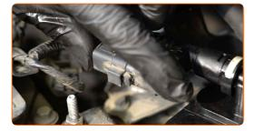
Füllen Sie den neuen Filter mit Kraftstoff.
