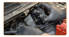
Reinigen Sie den Kraftstofffilter. Verwenden Sie Allzweckreinigungsspray.
