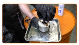
Reinigen Sie die Abdeckung und das Gehäuse des Kraftstofffilters. Verwenden Sie Allzweckreinigungsspray.
