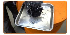
Schrauben Sie die Befestigungen vom Deckel des Kraftstofffiltergehäuses ab. Verwenden Sie den Torx T15. Verwenden Sie einen Ratschenschlüssel.
