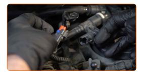
Drücken Sie die Clips zusammen und lösen Sie die Kraftstoffzufuhrleitungen vom Kraftstofffiltergehäuse. Verwenden Sie einen flachen Schraubendreher.
