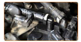
Verbinden Sie das Entlüftungskit mit der Kraftstofffilter-Entlüftungsschraube.
