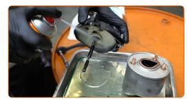
Installieren Sie den Deckel des Kraftstofffiltergehäuse und ziehen Sie ihn an. Verwenden Sie den Torx T15. Verwenden Sie einen Ratschenschlüssel.
