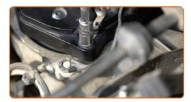
Bringen Sie den Anschluss des Kraftstoffdrucksensors an.
