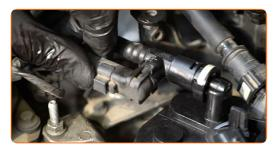
Bringen Sie den Anschluss des Kraftstoffdrucksensors an.
