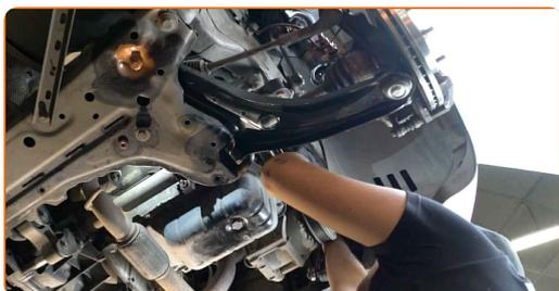
**131** Schrauben Sie die Befestigung des Lichtmaschinenkabelbaums ein. Verwenden Sie Stecknuss Nr. 13. Verwenden Sie einen Ratschenschlüssel.
