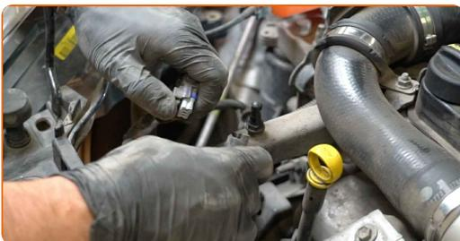
**21** Schrauben Sie die Befestigungen der Halterung des Motorkabelbaums ab. Verwenden Sie Stecknuss Nr. 10. Verwenden Sie einen Ratschenschlüssel.
