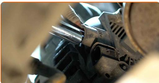
**18** Lösen Sie den Lichtmaschinenkabelbaum.
