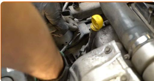
**20** Trennen Sie den Steckverbinder des Motorkabelbaums.
