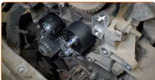
**82** Schrauben Sie die Befestigung der Umlenkriemenscheibe des Zahnriemens fest. Verwenden Sie Stecknuss Nr. 16. Verwenden Sie einen Drehmomentschlüssel. Ziehen Sie ihn mit 37 Nm Drehmoment fest.
