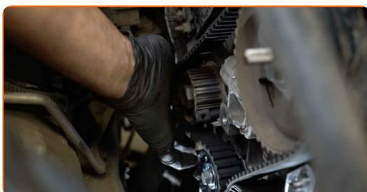
**Austausch: Zahnriemensatz mit Wasserpumpe – FORD Mondeo Mk5 Schrägheck (CE). Tipp von AUTODOC:**
