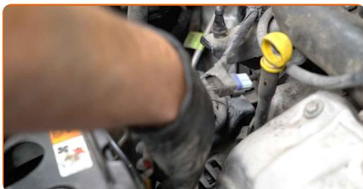
**128** Bringen Sie den Clip des Lichtmaschinenkabelbaums an der Halterung an.
