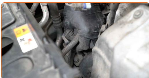
**129** Verbinden Sie den Steckverbinder des Kurbelwellensensors.
