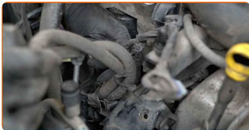
**127** Bringen Sie den Clip des Motorkabelbaums an der Zahnriemenabdeckung an.
