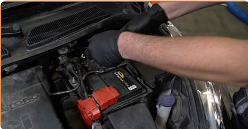
**4** Entfernen Sie die Batterieklemmen.
