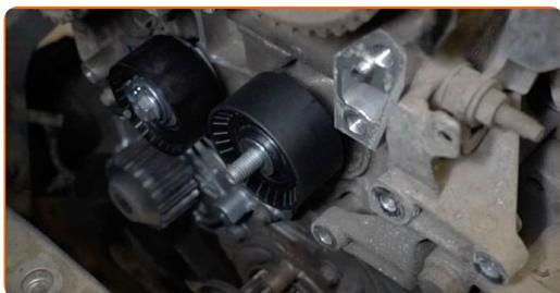
**81** Behandeln Sie die Befestigungsschraube. Verwenden Sie ein Dichtmittel.
