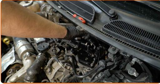
**23** Verbinden Sie die Kraftstoffleitungen zum Kraftstofffilter und verriegeln Sie die Befestigungsklammern.
