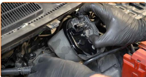
**11** Reinigen Sie den Kraftstofffilter. Verwenden Sie Allzweckreinigungsspray.
