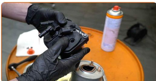
**16** Installieren Sie einen neuen Kraftstofffilter.
