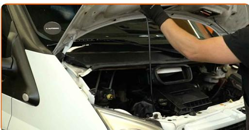
**2** Verwenden Sie einen Kotflügelschoner, um Schäden am Lack und den Kunststoffteilen des Autos zu verhindern.
