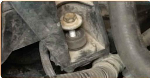
**69** Schrauben Sie die Befestigungsschrauben des Luftfiltergehäuses fest. Verwenden Sie eine Stecknuss mit einem Durchmesser von 10 mm. Verwenden Sie einen Ratschenschlüssel.
