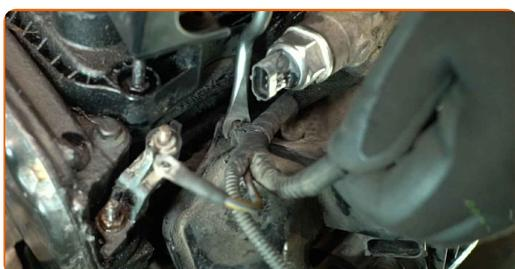
**21** Reinigen Sie die Befestigungsschrauben der Halterung des Ölmesstabs. Benutzen Sie eine Drahtbürste. Verwenden Sie WD-40-Spray.
