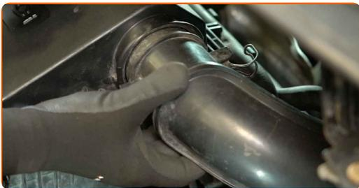
**5** Lösen Sie die Halteklammern der Luftfilterabdeckung.
