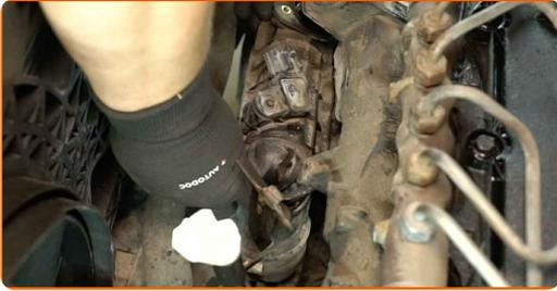
**28** Stopfen Sie den Ansaugschlauch mit einem Papiertuch zu, um zu vermeiden, dass Staub und Schmutz in das Luftfiltersystem gelangen.
