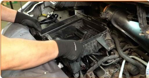
**67** Befestigen Sie die Gummischläuche am Luftfiltergehäuse.
