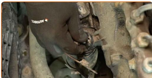
**27** Ziehen Sie den Ansaugschlauch vom Ansaugkrümmer ab.
