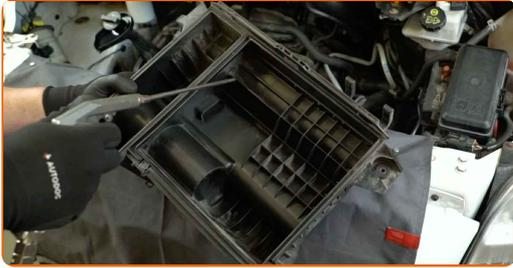
**66** Setzen Sie das Luftfiltergehäuse ein.
