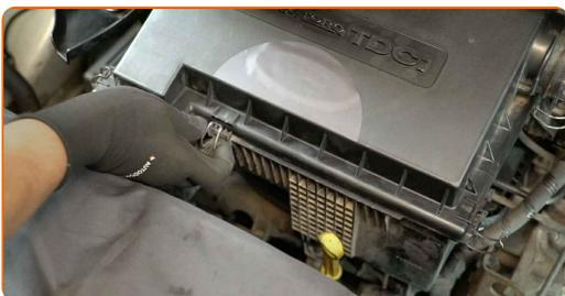
**6** Entfernen Sie die Luftfilterabdeckung.
