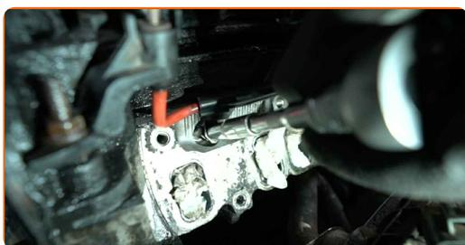
**43** Ziehen Sie die Muttern der Stromanschlüsse fest. Verwenden Sie eine Stecknuss mit einem Durchmesser von 7 mm. Verwenden Sie einen Drehmomentschlüssel. Anzugsdrehmoment: 4 N·m.
