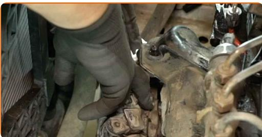
**29** Schrauben Sie die Befestigungsschrauben des Ansaugkrümmers ab. Verwenden Sie eine Stecknuss mit einem Durchmesser von 10 mm. Verwenden Sie einen Ratschenschlüssel.
