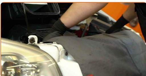
**3** Lösen Sie die Halteklammern des Ansaugschlauchs.
