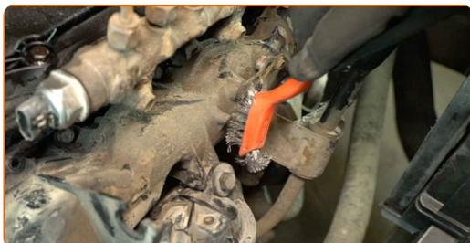
**22** Lösen Sie die Befestigungsschrauben der Halterung des Ölmesstabs. Verwenden Sie eine Stecknuss mit einem Durchmesser von 8 mm. Verwenden Sie einen Ratschenschlüssel.
