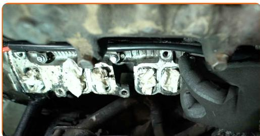
**42** Schrauben Sie die Muttern der Stromanschlüsse auf.
