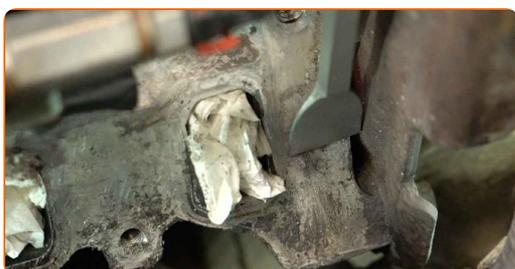
**45** Entfernen Sie die Ansaugkrümmerdichtungen.
