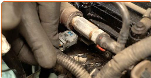
**20** Lösen Sie die Befestigung des Kabelbaums und schieben Sie den Kabelbaum zur Seite. Verwenden Sie einen Lösehebel.
