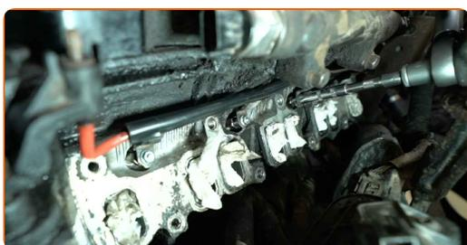
**44** Reinigen Sie die Aufnahme des Ansaugkrümmers. Verwenden Sie einen Dichtungsschaber. Verwenden Sie ein Allzweck-Reinigungsspray.
