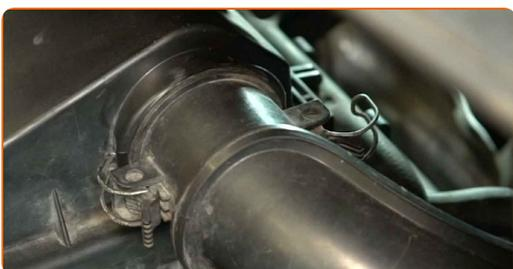
**4** Trennen Sie den Ansaugschlauch vom Luftfiltergehäuse.
