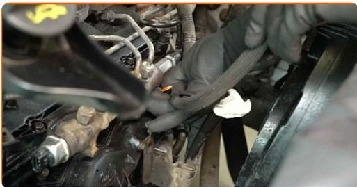
**61** Schließen Sie den Stecker des Nockenwellensensors an.
