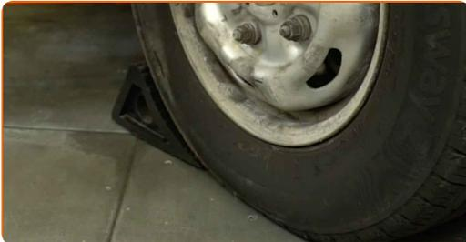
**2** Lockern Sie die Radmuttern an den Vorderrädern. Verwenden Sie eine Schlagnuss für Felgen mit einem Durchmesser von 21 mm. Verwenden Sie einen Drehstift.
