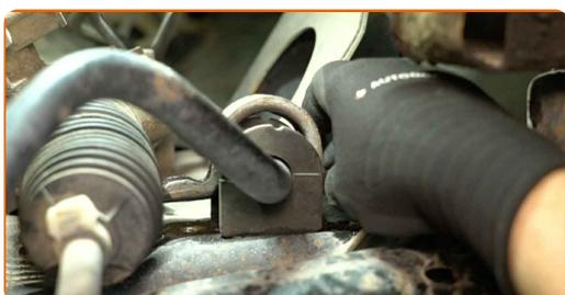
**15** Entfernen Sie das Stabilisatorlager.
