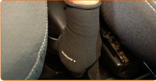
7 Reinigen Sie die Ausgleichsverbindung des Handbremsseils. Benutzen Sie eine Drahtbürste. Verwenden Sie WD-40-Spray.
