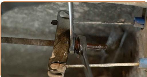
9 Trennen Sie das Handbremsseil von der Ausgleichsverbindung.
