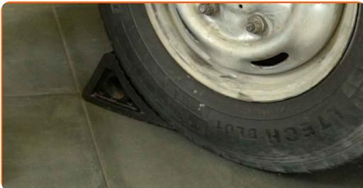
**2** Lockern Sie die Radmuttern. Verwenden Sie eine Schlagnuss für Felgen mit einem Durchmesser von 21 mm. Verwenden Sie einen Drehstift.
