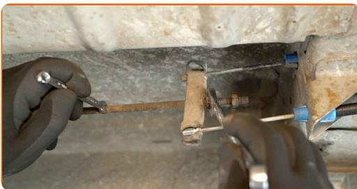
**34** Ziehen Sie die Kontermutter an der Einstellmutter fest. Verwenden Sie zwei Ringmaulschlüssel mit einem Durchmesser von 13 mm.
