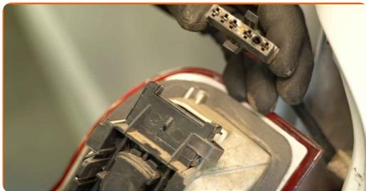
**5** Entfernen Sie die Lampenfassung zusammen mit den Glühlampen.
