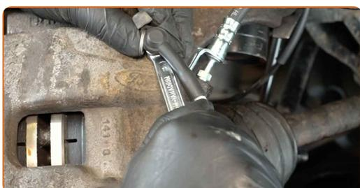
30 Betätigen Sie das Bremspedal mehrmals, um Luft aus der Anlage zu entfernen.
