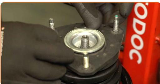
**62** Bringen Sie die Mutter der Kolbenstange des Federbeins an und ziehen Sie sie fest. Verwenden Sie einen Zapfenschlüssel für Federbeine mit einem Durchmesser von 18 mm. Verwenden Sie eine H6-Sechskant-Verlängerung. Verwenden Sie einen Drehmomentschlüssel. Anzugsdrehmoment: 70 N·m.
