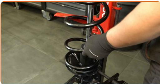
**59** Montieren Sie eine Staubmanschette, einen Anschlagpuffer und ein Domlager.
