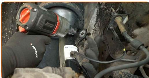
**23** Lösen Sie die Mutter, mit der die Koppelstange am Federbein befestigt ist. Verwenden Sie einen Ringmaulschlüssel mit einem Durchmesser von 19 mm. Verwenden Sie ein H5-Sechskant-Bit. Verwenden Sie einen Ratschenschlüssel.
