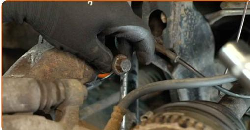
**42** Trennen Sie den Achsschenkel vom Federbein. Verwenden Sie einen Gummihammer. Verwenden Sie einen Getriebeheber oder einen weiteren Wagenheber.
