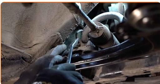
**10** Entfernen Sie die Stabilisatorbuchsen.
