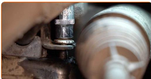
**15** Schrauben Sie die Befestigungen der Stabilisatorbuchsenhalter ein. Verwenden Sie Stecknuss Nr. E12. Verwenden Sie einen Drehmomentschlüssel. Ziehen Sie ihn mit 35 Nm Drehmoment fest.
