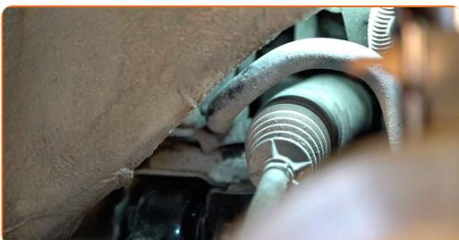
**11** Reinigen Sie die Montagesitze der Stabilisatorbuchsen. Benutzen Sie WD-40-Spray.
