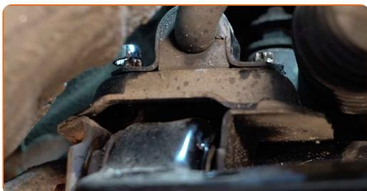
**8** Entfernen Sie die Befestigungsschrauben (2 Stück).
