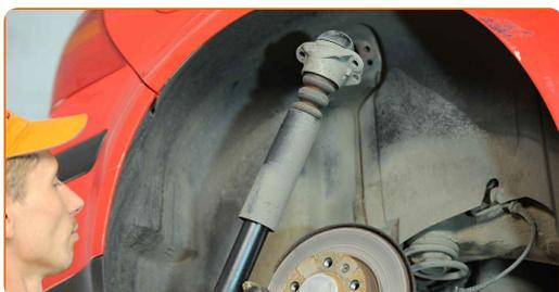
**12** Entfernen Sie die Schutzkappe der Stoßdämpferhalterung. Verwenden Sie einen flachen Schraubendreher.
