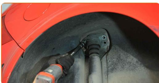
**11** Den Stoßdämpfer entfernen.
