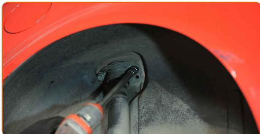
**10.2** Verwenden Sie Stecknuss Nr. 16. Verwenden Sie ein Windeisen.
