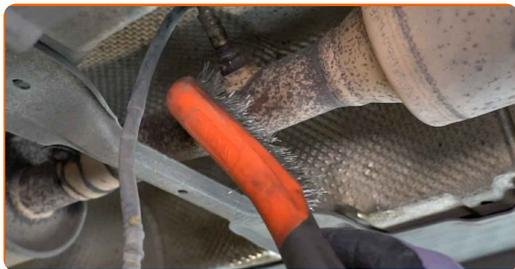
**9** Lösen Sie die Befestigung der Lambdasonde. Verwenden Sie Ring-Gabelschlüssel Nr. 22.
