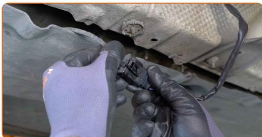
**17** Schließen Sie die Verkabelung des Sauerstoffsensors an.
