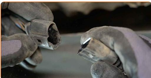
**8** Reinigen Sie die Befestigung der Lambdasonde. Benutzen Sie eine Drahtbürste. Benutzen Sie WD-40-Spray.
