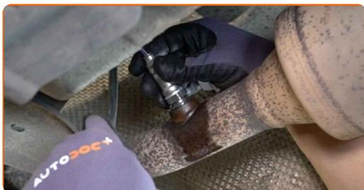
**14** Ziehen Sie die Befestigung der Lambdasonde fest. Verwenden Sie Ring-Gabelschlüssel Nr. 22. Verwenden Sie einen Drehmomentschlüssel. Ziehen Sie ihn mit 37 Nm Drehmoment fest.
