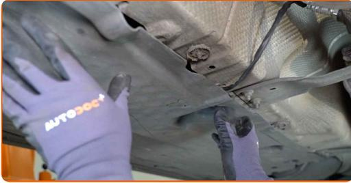
**19** Ziehen Sie die Befestigungen der unteren Ölwanne-Abdeckung fest. Verwenden Sie Stecknuss Nr. 10. Verwenden Sie einen Ratschenschlüssel.
