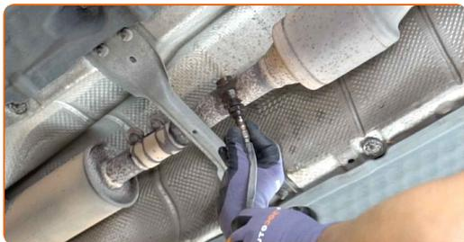
**11** Schneiden Sie das Gewinde für die neue Lambdasonde. Verwenden Sie einen Gewindebohrer. Verwenden Sie einen Ratschenschlüssel.
