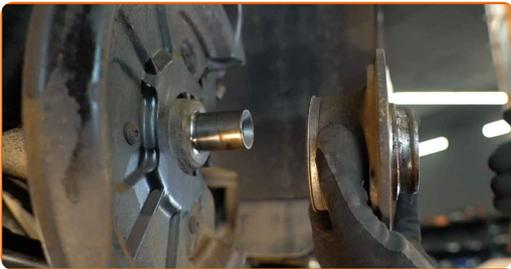
20 Reinigen Sie den Einbauort für die Nabenlagerung. Verwenden Sie Allzweckreinigungsspray.
