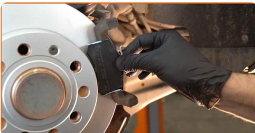
32 Installieren Sie den Bremssattel und fixieren Sie diesen. Verwenden Sie Ring-Gabelschlüssel Nr. 13. Verwenden Sie Stecknuss Nr. 13. Verwenden Sie einen Drehmomentschlüssel. Ziehen Sie ihn mit 35 Nm Drehmoment fest.
