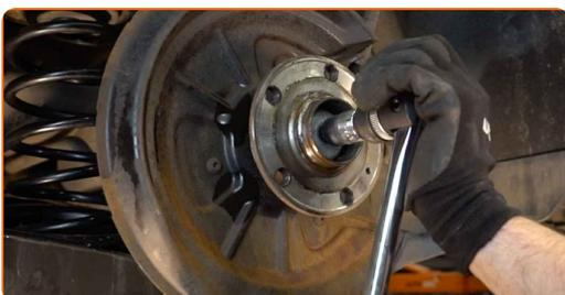
18 Entfernen Sie die Befestigungsschraube.
