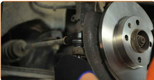
**16** Ziehen Sie die Befestigungsmutter an, die den Spurstangenkopf mit dem Achsschenkel verbindet. Verwenden Sie Stecknuss Nr. 19. Verwenden Sie einen Drehmomentschlüssel. Ziehen Sie ihn mit 35 Nm Drehmoment fest.
