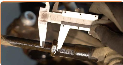
**7** Reinige die Kontermutter, die die Spurstange mit dem Spurstangenkopf verbindet. Benutzen Sie eine Drahtbürste. Benutzen Sie WD-40-Spray.
