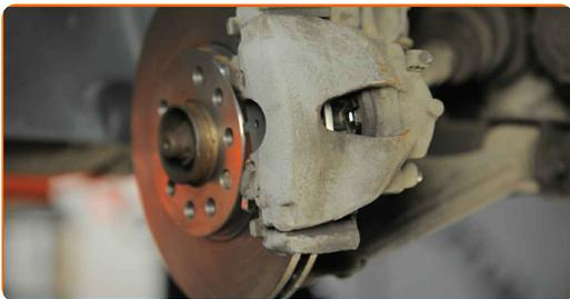
**31.2** Verwenden Sie Inbusschlüssel Nr. H7. Verwenden Sie einen Drehmomentschlüssel. Ziehen Sie ihn mit 30 Nm Drehmoment fest.
