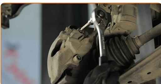
**32** Installieren Sie die Staubschutzkappen der Bremssattel-Führungsstifte.
