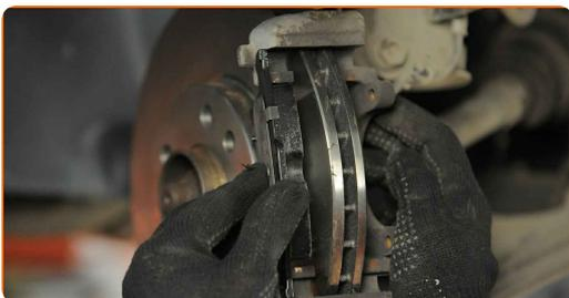
**31.1** Installieren Sie den Bremssattel und fixieren Sie diesen.
