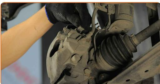
**33** Bauen Sie die Bremssattel-Haltefeder ein. Verwenden Sie einen flachen Schraubendreher. Verwenden Sie Zangen.
