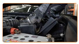
Bedecken Sie den Luftansaugschlauch mit einem Mikrofasertuch, um zu vermeiden, dass Staub und Schmutz in das System gelangen.
