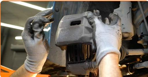
**Austausch: Bremsbeläge – HONDA CITY Stufenheck (GM). Fachleute empfehlen:**
