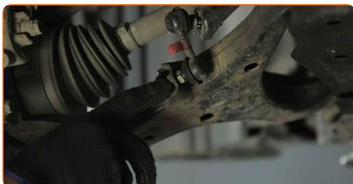
**7** Schrauben Sie das Befestigungselement heraus, das die Druckstange mit dem Stabilisator verbindet. Verwenden Sie Ring-Gabelschlüssel Nr. 14 (2 Teile).
