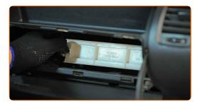
Entfernen Sie das Innenraumfiltergehäuse.
