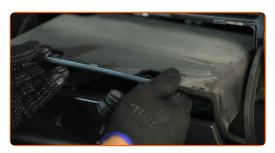
Lösen Sie die Befestigungsclips der Innenraumfilterabdeckung.
