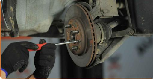
**16** Entfernen Sie die Bremsscheibe.
