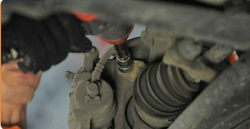
**12** Entfernen Sie die Befestigungsschrauben (2 Stück).
