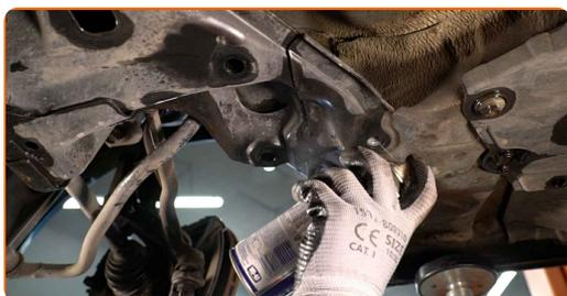
**20** Installieren Sie den Arm. Benutzen Sie ein Brecheisen.
