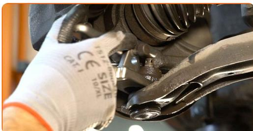
**13** Reinigen Sie alle Verbindungen des Querlenkers. Benutzen Sie eine Drahtbürste. Benutzen Sie WD-40-Spray.
