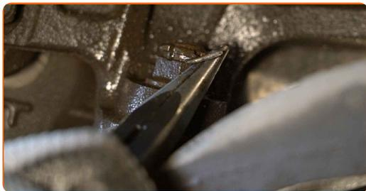
**11** Schrauben Sie die Kugelgelenkbefestigung vom Achsschenkel ab. Verwenden Sie Ring-Gabelschlüssel Nr. 19.
