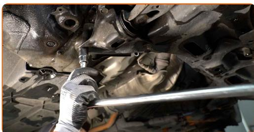
**16** Lösen Sie die hintere Befestigung des Querlenkers. Verwenden Sie Stecknuss Nr. 19.
