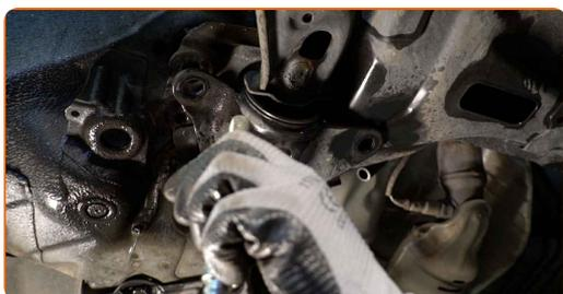
**17** Entfernen Sie die vordere Befestigung des Querlenkers. Verwenden Sie Stecknuss Nr. 19.
