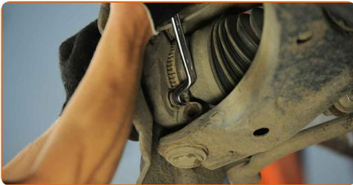
**18.2** Verwenden Sie Stecknuss Nr. 14. Verwenden Sie einen Ratschenschlüssel.
