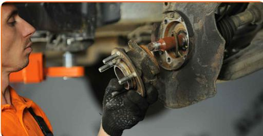
**22** Reinigen Sie den Befestigungssitz der Radnabe. Verwenden Sie Allzweckreinigungsspray.
