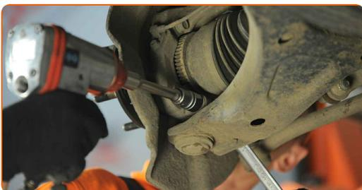
**16** Entfernen Sie die Befestigungsschraube. Benutzen Sie einen Hammer. Verwenden Sie einen Splintentreiber.
