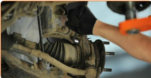
**19** Entfernen Sie die Befestigungsschrauben.
