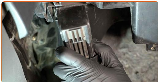
**4** Entfernen Sie den Gehäusedeckel des Innenraumfilters.
