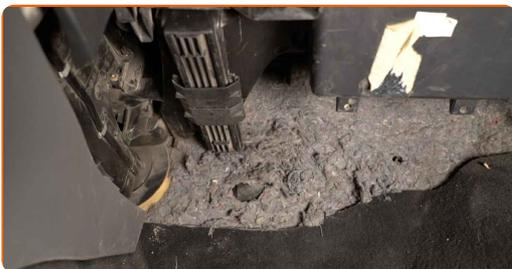
**3** Lösen Sie die Clips der Innenraumfilterabdeckung.
