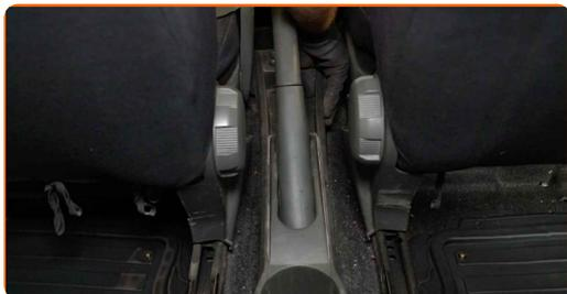
**35** Schrauben Sie die vorderen Befestigungen der unteren Mittelkonsole ein. Verwenden Sie Stecknuss Nr. 10. Verwenden Sie einen Ratschenschlüssel.
