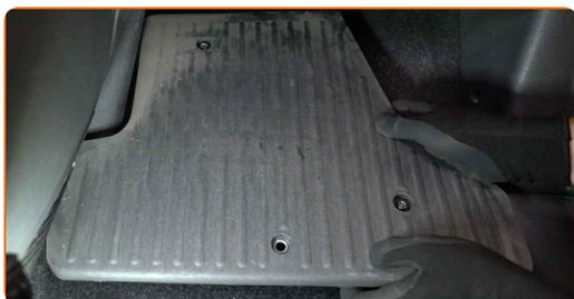
**4** Entfernen Sie die Seitenabdeckung aus Kunststoff.
