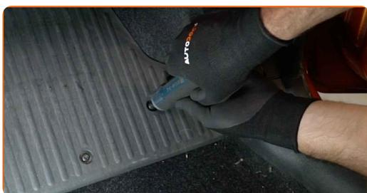
**3** Entfernen Sie die Fußstütze.
