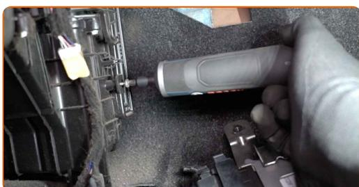
**6** Entfernen Sie den Gehäusedeckel des Innenraumfilters.
