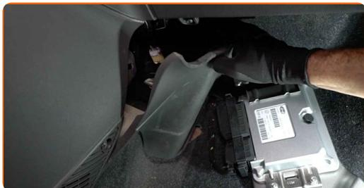
**5** Schrauben Sie die Verbindungselemente der Innenfilter-Gehäuseabdeckung ab. Verwenden Sie einen Kreuzschlitzschraubendreher. Verwenden Sie einen Ratschenschlüssel.
